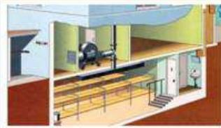
Противорадиационное укрытие — защитное сооружение гражданской обороны, предназначенное для защиты укрываемых от воздействия ионизирующих излучений при радиоактивном заражении (загрязнении) местности и допускающее непрерывное пребывание в нем укрываемых в течение определенного времени.
